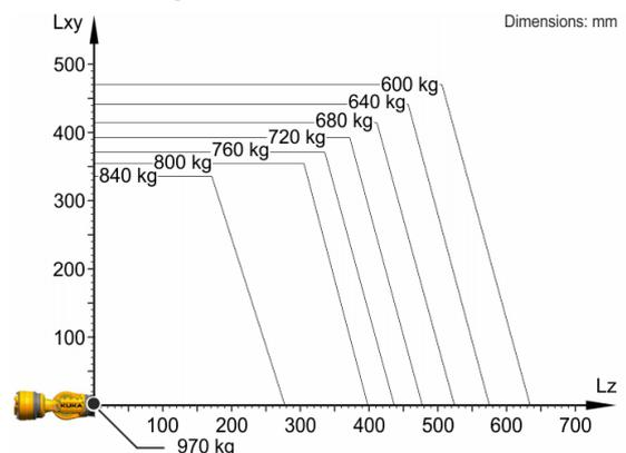
KR 800 R2800-2 está configurado para una carga nominal de 800 kg para aprovechar de forma óptima el rendimiento y la dinámica del robot. Con distancias de carga reducidas y cargas adicionales favorables, puede instalarse una carga máxima de hasta 970 kg. La situación de carga concreta debe controlarse con KUKA Load. Para un asesoramiento individual, póngase en contacto con KUKA Service.
