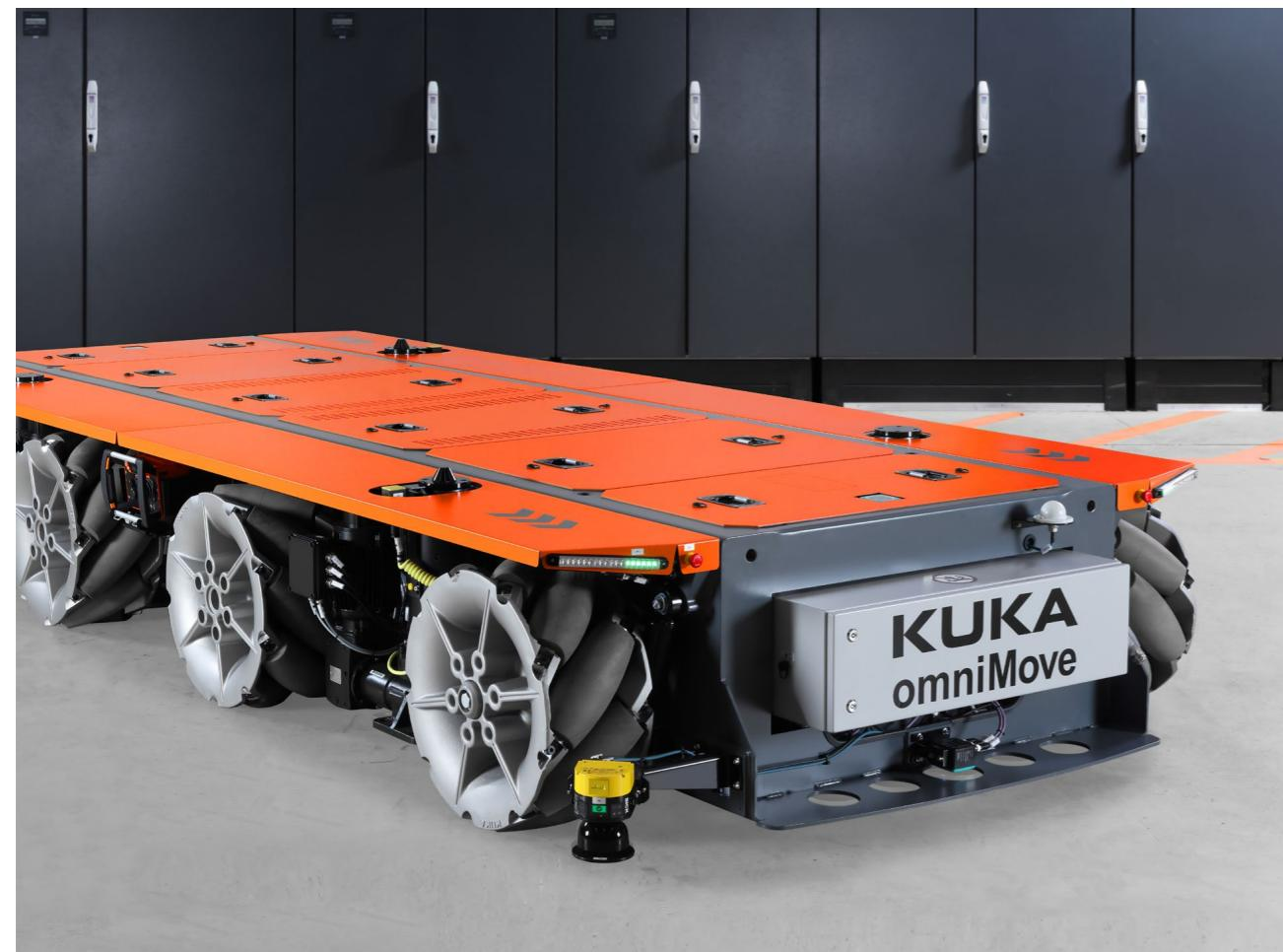
**Kraftvoll.** Je nach Fahrzeugvariante bewegt der KUKA omniMove selbst schwerste Bauteile im XXL-Format sicher und komfortabel. Er schafft Traglasten von bis zu 100 Tonnen und – in der Maximalversion – bis zu 30 Metern Länge.
