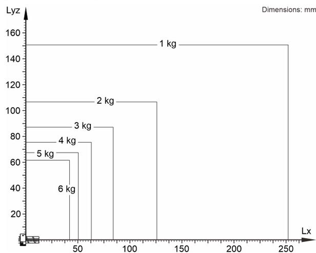
KR 6 R500 Z200-2 está configurado para una carga nominal de 3 kg para aprovechar de forma óptima el rendimiento y la dinámica del manipulador. Con intervalos de carga reducidos también se pueden aplicar cargas superiores hasta la capacidad de carga máxima. La situación de carga concreta debe controlarse con KUKA.Load. Para un asesoramiento individual, póngase en contacto con KUKA Support.
