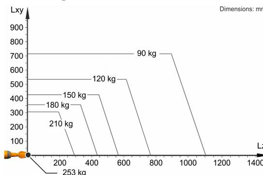
KR 180 R2900-2 está configurado para una carga nominal de 180 kg para aprovechar de forma óptima el rendimiento y la dinámica del robot. Solo si la posición del centro de gravedad de la masa es de 0 mm y se ha aplicado una carga adicional optimizada para la situación de carga, se aplica la carga máxima de 253 kg. La situación de carga específica debe comprobarse con KUKA.Load o KUKA Compose. Para un asesoramiento individual, póngase en contacto con KUKA Support.
