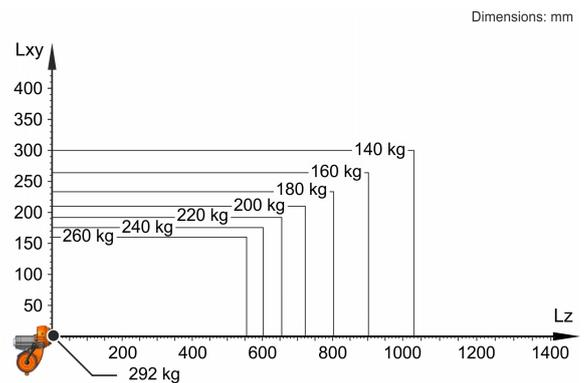
KR 240 R3200-2 PA está configurado para una carga nominal de 240 kg para aprovechar de forma óptima el rendimiento y la dinámica del robot. Con distancias de carga reducidas y cargas adicionales favorables, puede instalarse una carga máxima de hasta 292 kg. La situación de carga concreta debe controlarse con KUKA Load. Para un asesoramiento individual, póngase en contacto con KUKA Service.
