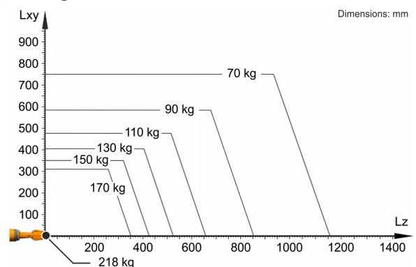
Der KR 150 R2700-2 F ist ausgelegt für eine Nenn-Traglast von 150 kg, um die Performance und Dynamik des Roboters optimal zu nutzen. Nur wenn die Lage des Massenschwerpunkts 0 mm und eine für den Lastfall optimierte Zusatzlast angebracht sind, gilt die maximale Traglast von 218 kg. Der spezifische Lastfall muss mit KUKA.Load oder KUKA Compose überprüft werden. Für weitere Beratung steht der KUKA Support zur Verfügung.
