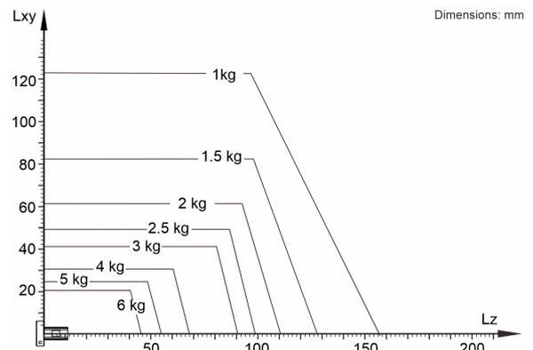
Der KR 3 D1200 HM ist ausgelegt für eine Nenn-Traglast von 3 kg, um die Performance und Dynamik des Roboters optimal zu nutzen. Mit reduzierten Lastabständen und günstigen Zusatzlasten, kann eine maximale Traglast bis zu 6 kg angebracht werden. Der spezifische Lastfall muss mit KUKA Load überprüft werden. Für weitere Beratung steht der KUKA Service zur Verfügung.
