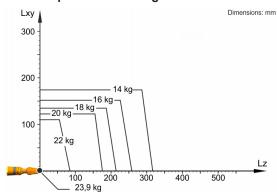
O KR 20 R1810 F está configurado para uma capacidade de carga nominal de 20 kg, para usar de forma ideal o desempenho e a dinâmica do robô. Somente se a posição do centro de gravidade da massa for 0 mm e estiver colocada uma carga adicional otimizada para o caso de carga, é válida a capacidade de carga máxima de 23,9 kg. O caso de carga específico deve ser controlado com KUKA.Load ou KUKA Compose. O Suporte KUKA está à sua disposição para maiores detalhes.
