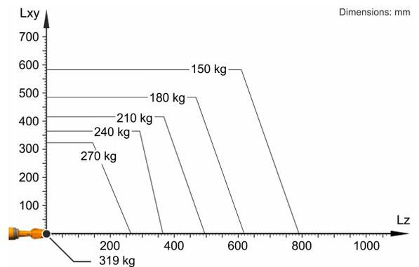
로봇의 실행력과 다이내믹의 사용을 최적화하기 위해 KR 240 R2900-2 F는 240 kg의 정격 가반하중용으로 설계되었습니다. 무게중심의 위치가 0 mm에 있고 부하 케이스에 최적화된 부가하중이 부착된 경우에만 319 kg의 최대 가반하중이 유효합니다. 특수 부하 케이스는 KUKA.Load 또는 KUKA Compose를 이용해 점검해야 합니다. 추가적 상담에 관해 KUKA 서포트에 언제든지 연락하실 수 있습니다.
