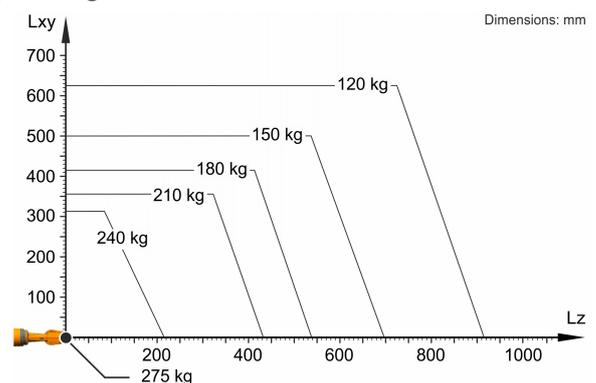
Der KR 210 R2700-2 F ist ausgelegt für eine Nenn-Traglast von 210 kg, um die Performance und Dynamik des Roboters optimal zu nutzen. Nur wenn die Lage des Massenschwerpunkts 0 mm und eine für den Lastfall optimierte Zusatzlast angebracht sind, gilt die maximale Traglast von 275 kg. Der spezifische Lastfall muss mit KUKA.Load oder KUKA Compose überprüft werden. Für weitere Beratung steht der KUKA Support zur Verfügung.
