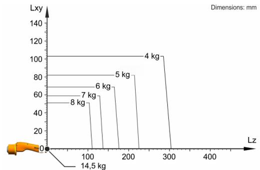
O KR 8 R1440-2 arc HW está configurado para uma capacidade de carga nominal de 8 kg, para usar de forma ideal o desempenho e a dinâmica do robô. Com distâncias de carga reduzidas e cargas adicionais favoráveis, pode ser instalada uma capacidade de carga máxima de até 14,5 kg. O caso de carga específico deve ser verificado com KUKA Load. O KUKA Service está à sua disposição para mais consultoria.
