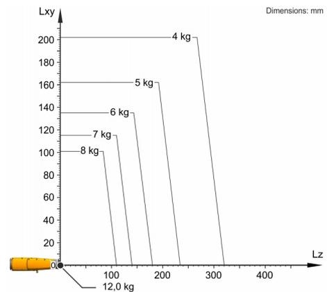
KR 8 R1640-2 está configurado para una carga nominal de 8 kg para aprovechar de forma óptima el rendimiento y la dinámica del robot. Solo si la posición del centro de gravedad de la masa es de 0 mm y se ha aplicado una carga adicional optimizada para la situación de carga, se aplica la carga máxima de 12 kg. La situación de carga específica debe comprobarse con KUKA.Load o KUKA Compose. Para un asesoramiento individual, póngase en contacto con KUKA Support.
