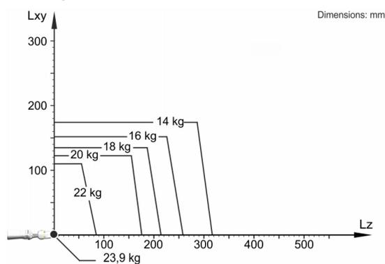
Il KR 20 R1810 CR è progettato per una portata nominale di 20 kg in grado di sfruttare al meglio le prestazioni e la dinamicità del robot. Il carico utile massimo di 23,9 kg vale solo quando sono applicati una posizione del baricentro di 0 mm e un carico aggiuntivo ottimizzato per la situazione di carico. La situazione di carico specifica deve essere verificata con KUKA.Load o KUKA Compose. Per un'ulteriore consulenza il servizio di assistenza KUKA rimane a vostra disposizione.
