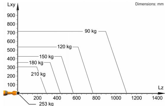
Der KR 180 R2900-2 ist ausgelegt für eine Nenn-Traglast von 180 kg, um die Performance und Dynamik des Roboters optimal zu nutzen. Nur wenn die Lage des Massenschwerpunkts 0 mm und eine für den Lastfall optimierte Zusatzlast angebracht sind, gilt die maximale Traglast von 253 kg. Der spezifische Lastfall muss mit KUKA.Load oder KUKA Compose überprüft werden. Für weitere Beratung steht der KUKA Support zur Verfügung.
