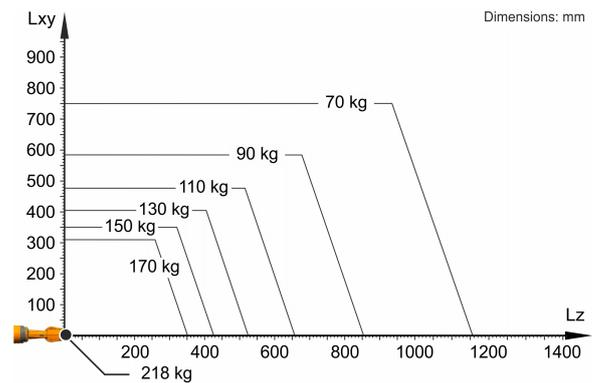
KR 150 R2700-2 は、ロボットの性能とダイナミクスを最適に使用するため、150 kg の公称可搬重量用に設計されています。質量の重心が 0 mm であり、荷重のケースに対して最適化された追加荷重がかけられている場合限り、最大の可搬重量が適用されます 218 kg。特定の荷重のケースでは、KUKA.Load または KUKA Compose を用いた確認が必要です。その他のアドバイスに関しては、KUKA サポートにお気軽にお尋ねください。
