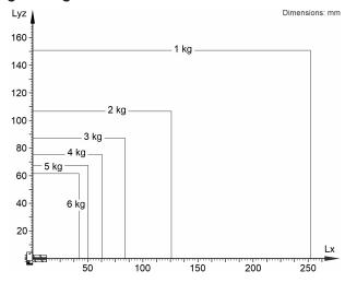
Der KR 6 R500 Z200-2 ist für eine Nenn-Traglast von 3 kg ausgelegt, um die Performance und Dynamik des Manipulators optimal zu nutzen. Mit reduzierten Lastabständen können auch höhere Lasten bis zur maximalen Traglast zur Anwendung kommen. Der spezifische Lastfall muss mit KUKA.Load überprüft werden. Für weitere Beratung steht der KUKA Support zur Verfügung.
