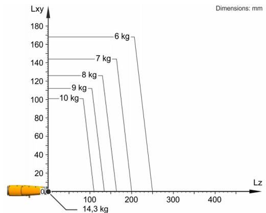
Der KR 10 R1440-2 ist ausgelegt für eine Nenn-Traglast von 10 kg, um die Performance und Dynamik des Roboters optimal zu nutzen. Mit reduzierten Lastabständen und günstigen Zusatzlasten, kann eine maximale Traglast bis zu 14,3 kg angebracht werden. Der spezifische Lastfall muss mit KUKA Load überprüft werden. Für weitere Beratung steht der KUKA Service zur Verfügung.
