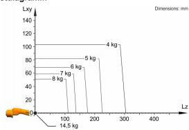
Der KR 8 R1440-2 arc HW ist ausgelegt für eine Nenn-Traglast von 8 kg, um die Performance und Dynamik des Roboters optimal zu nutzen. Mit reduzierten Lastabständen und günstigen Zusatzlasten, kann eine maximale Traglast bis zu 14,5 kg angebracht werden. Der spezifische Lastfall muss mit KUKA Load überprüft werden. Für weitere Beratung steht der KUKA Service zur Verfügung.
