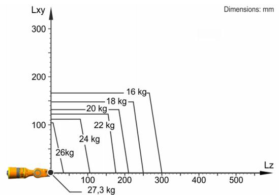
KR 22 R1610-2 está configurado para una carga nominal de 22 kg para aprovechar de forma óptima el rendimiento y la dinámica del robot. Solo si la posición del centro de gravedad de la masa es de 0 mm y se ha aplicado una carga adicional optimizada para la situación de carga, se aplica la carga máxima de 27,3 kg. La situación de carga específica debe comprobarse con KUKA.Load o KUKA Compose. Para un asesoramiento individual, póngase en contacto con KUKA Support.
