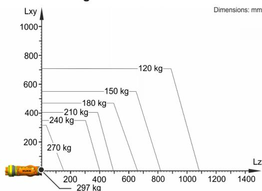
KR 240 R3330 est conçu pour une charge nominale de 240 kg pour une utilisation optimale de la performance et de la dynamique du robot. Seulement si la position du centre de gravité = 0 mm et une charge supplémentaire optimisée pour le cas de charge sont attachées, la charge maximale de 297 kg s'applique. Les cas de charge spécifiques doivent être contrôlés avec KUKA Load ou KUKA Compose. Notre assistance technique KUKA Support est à votre disposition pour vous conseiller.
