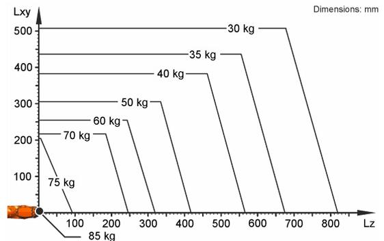
Il KR 70 R2100 F è progettato per una portata nominale di 70 kg in grado di sfruttare al meglio le prestazioni e la dinamicità del robot. Con distanze di carico ridotte e carichi aggiuntivi favorevoli è possibile applicare un carico utile massimo di 85 kg. La situazione di carico specifica deve essere verificata con KUKA Load. Per un'ulteriore consulenza il servizio di assistenza KUKA rimane a vostra disposizione.
