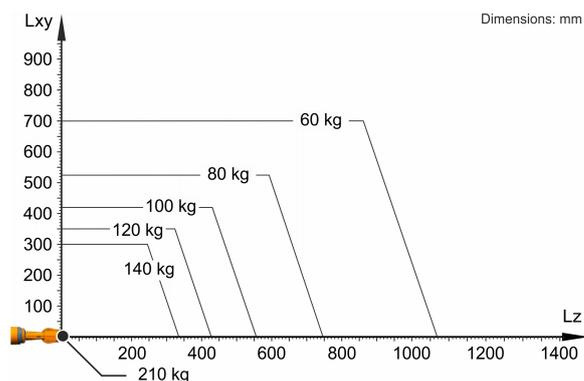
Il KR 120 R3100-2 F è progettato per una portata nominale di 120 kg in grado di sfruttare al meglio le prestazioni e la dinamicità del robot. Il carico utile massimo di 210 kg vale solo quando sono applicati una posizione del baricentro di 0 mm e un carico aggiuntivo ottimizzato per la situazione di carico. La situazione di carico specifica deve essere verificata con KUKA.Load o KUKA Compose. Per un'ulteriore consulenza il servizio di assistenza KUKA rimane a vostra disposizione.
