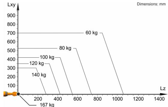
KR 120 R2700-2 está configurado para una carga nominal de 120 kg para aprovechar de forma óptima el rendimiento y la dinámica del robot. Solo si la posición del centro de gravedad de la masa es de 0 mm y se ha aplicado una carga adicional optimizada para la situación de carga, se aplica la carga máxima de 167 kg. La situación de carga específica debe comprobarse con KUKA.Load o KUKA Compose. Para un asesoramiento individual, póngase en contacto con KUKA Support.
