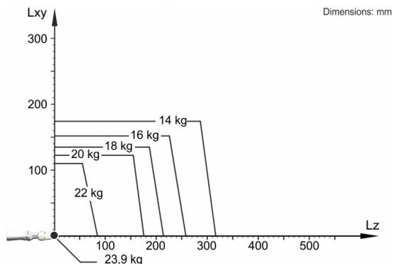
Der KR 20 R1810 HO ist ausgelegt für eine Nenn-Traglast von 20 kg, um die Performance und Dynamik des Roboters optimal zu nutzen. Nur wenn die Lage des Massenschwerpunkts 0 mm und eine für den Lastfall optimierte Zusatzlast angebracht sind, gilt die maximale Traglast von 23,9 kg. Der spezifische Lastfall muss mit KUKA.Load oder KUKA Compose überprüft werden. Für weitere Beratung steht der KUKA Support zur Verfügung.
