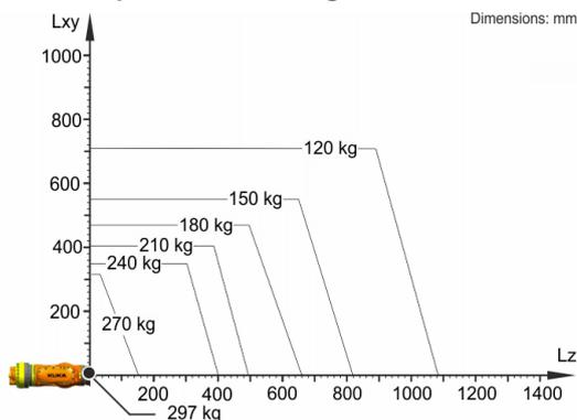
O KR 240 R3330 C está configurado para uma capacidade de carga nominal de 240 kg, para usar de forma ideal o desempenho e a dinâmica do robô. Somente se a posição do centro de gravidade da massa for 0 mm e estiver colocada uma carga adicional otimizada para o caso de carga, é válida a capacidade de carga máxima de 297 kg. O caso de carga específico deve ser controlado com KUKA.Load ou KUKA.Compose. O Suporte KUKA está à sua disposição para maiores detalhes.
