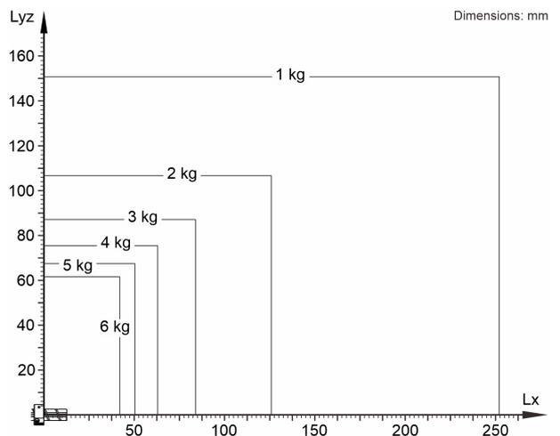
Der KR 6 R500 Z200 ist für eine Nenn-Traglast von 3 kg ausgelegt, um die Performance und Dynamik des Manipulators optimal zu nutzen. Mit reduzierten Lastabständen können auch höhere Lasten bis zur maximalen Traglast zur Anwendung kommen. Der spezifische Lastfall muss mit KUKA.Load überprüft werden. Für weitere Beratung steht der KUKA Support zur Verfügung.
