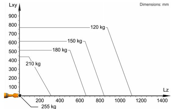
Der KR 210 R3100-2 C ist ausgelegt für eine Nenn-Traglast von 210 kg, um die Performance und Dynamik des Roboters optimal zu nutzen. Nur wenn die Lage des Massenschwerpunkts 0 mm und eine für den Lastfall optimierte Zusatzlast angebracht sind, gilt die maximale Traglast von 255 kg. Der spezifische Lastfall muss mit KUKA Load oder KUKA Compose überprüft werden. Für weitere Beratung steht der KUKA Support zur Verfügung.
