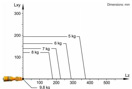
Der KR 8 R2010-2 ist ausgelegt für eine Nenn-Traglast von 8 kg, um die Performance und Dynamik des Roboters optimal zu nutzen. Nur wenn die Lage des Massenschwerpunkts 0 mm und eine für den Lastfall optimierte Zusatzlast angebracht sind, gilt die maximale Traglast von 9,8 kg. Der spezifische Lastfall muss mit KUKA.Load oder KUKA Compose überprüft werden. Für weitere Beratung steht der KUKA Support zur Verfügung.
