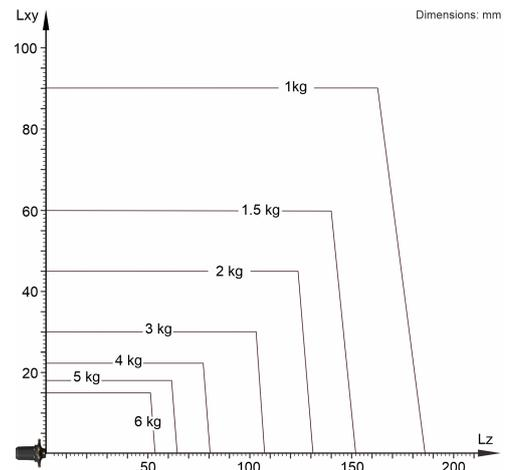
KR 3 D1200 设计用于 3 kg 的额定负载，以便最佳利用机器人的性能和动态性。在负载间隔缩小且具有合适的附加负载情况下，可以施加多达 6 kg 的最大负载。特殊的负载实例必须用 KUKA Load 进行检查。如果需要详细咨询，请联系 KUKA 服务部门。
