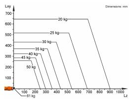
O KR 50 R2500 HO está configurado para uma capacidade de carga nominal de 50 kg, para usar de forma ideal o desempenho e a dinâmica do robô. Com distâncias de carga reduzidas e cargas adicionais favoráveis, pode ser instalada uma capacidade de carga máxima de até 61 kg. O caso de carga específico deve ser verificado com KUKA Load. O KUKA Service está à sua disposição para mais consultoria.
