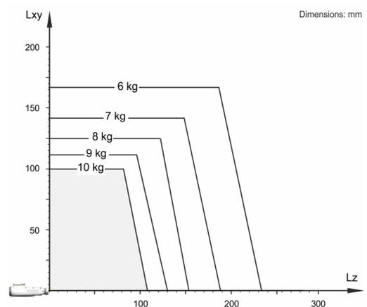
Der KR 10 R900 HM-SC ist ausgelegt für eine Nenn-Traglast von 5 kg, um die Performance und Dynamik des Roboters optimal zu nutzen. Nur wenn die Lage des Massenschwerpunkts 0 mm und eine für den Lastfall optimierte Zusatzlast angebracht sind, gilt die maximale Traglast von 10 kg. Der spezifische Lastfall muss mit KUKA.Load oder KUKA Compose überprüft werden. Für weitere Beratung steht der KUKA Support zur Verfügung.
