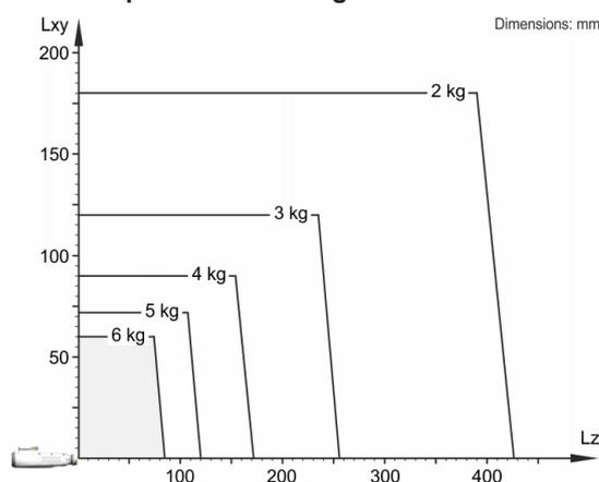
O KR 6 R900 HM-SC está configurado para uma capacidade de carga nominal de 3 kg, para usar de forma ideal o desempenho e a dinâmica do robô. Somente se a posição do centro de gravidade da massa for 0 mm e estiver colocada uma carga adicional otimizada para o caso de carga, é válida a capacidade de carga máxima de 6 kg. O caso de carga específico deve ser controlado com KUKA.Load ou KUKA.Compose. O Suporte KUKA está à sua disposição para maiores detalhes.
