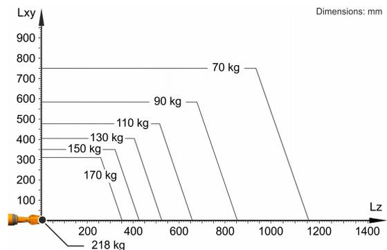
Der KR 150 R2700-2 ist ausgelegt für eine Nenn-Traglast von 150 kg, um die Performance und Dynamik des Roboters optimal zu nutzen. Nur wenn die Lage des Massenschwerpunkts 0 mm und eine für den Lastfall optimierte Zusatzlast angebracht sind, gilt die maximale Traglast von 218 kg. Der spezifische Lastfall muss mit KUKA.Load oder KUKA Compose überprüft werden. Für weitere Beratung steht der KUKA Support zur Verfügung.
