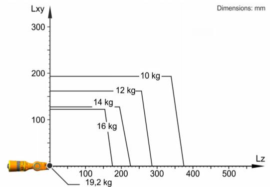
KR 16 R2010-2 は、ロボットの性能とダイナミクスを最適に使用するため、16 kg の公称可搬重量用に設計されています。質量の重心が 0 mm であり、荷重のケースに対して最適化された追加荷重がかけられている場合に限り、最大の可搬重量が適用されます 19.2 kg。特定の荷重のケースでは、KUKA.Load または KUKA Compose を用いた確認が必要です。その他のアドバイスに関しては、KUKA サポートにお気軽にお尋ねください。
