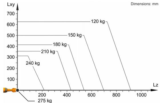
Der KR 210 R2700-2 ist ausgelegt für eine Nenn-Traglast von 210 kg, um die Performance und Dynamik des Roboters optimal zu nutzen. Nur wenn die Lage des Massenschwerpunkts 0 mm und eine für den Lastfall optimierte Zusatzlast angebracht sind, gilt die maximale Traglast von 275 kg. Der spezifische Lastfall muss mit KUKA.Load oder KUKA Compose überprüft werden. Für weitere Beratung steht der KUKA Support zur Verfügung.
