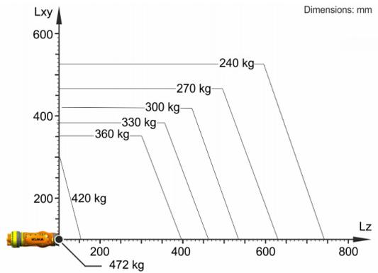
Der KR 360 R2830 C ist ausgelegt für eine Nenn-Traglast von 360 kg, um die Performance und Dynamik des Roboters optimal zu nutzen. Nur wenn die Lage des Massenschwerpunkts 0 mm und eine für den Lastfall optimierte Zusatzlast angebracht sind, gilt die maximale Traglast von 472 kg. Der spezifische Lastfall muss mit KUKA.Load oder KUKA Compose überprüft werden. Für weitere Beratung steht der KUKA Support zur Verfügung.
