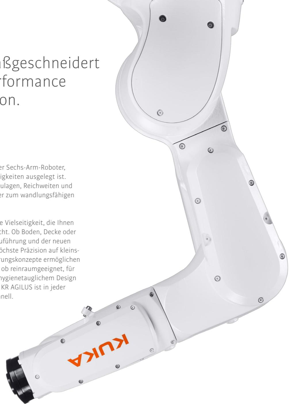
**Ausführung Hygienic Machine.** Der KR AGILUS ist als Hygienic Machine erhältlich. Design und Material sind bei dieser Variante absolut hygienetauglich. Das ermöglicht den Einsatz für Anwendungen mit direktem Kontakt zu Lebensmitteln und pharmazeutischen Substanzen.
