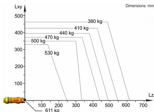
Il KR 500 R2830 C è progettato per una portata nominale di 500 kg in grado di sfruttare al meglio le prestazioni e la dinamicità del robot. Il carico utile massimo di 611 kg vale solo quando sono applicati una posizione del baricentro di 0 mm e un carico aggiuntivo ottimizzato per la situazione di carico. La situazione di carico specifica deve essere verificata con KUKA.Load o KUKA Compose. Per un'ulteriore consulenza il servizio di assistenza KUKA rimane a vostra disposizione.
