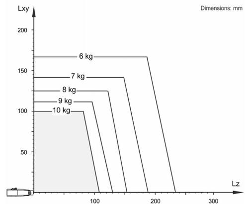
O KR 10 R1100 EX está configurado para uma capacidade de carga nominal de 5 kg, para usar de forma ideal o desempenho e a dinâmica do robô. Somente se a posição do centro de gravidade da massa for 0 mm e estiver colocada uma carga adicional otimizada para o caso de carga, é válida a capacidade de carga máxima de 10 kg. O caso de carga específico deve ser controlado com KUKA.Load ou KUKA Compose. O Suporte KUKA está à sua disposição para maiores detalhes.
