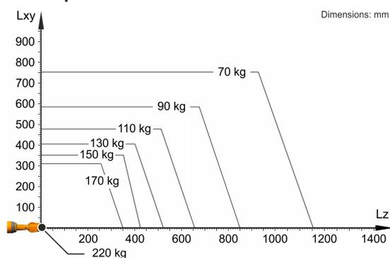
Il KR 150 R3100-2 è progettato per una portata nominale di 150 kg in grado di sfruttare al meglio le prestazioni e la dinamicità del robot. Il carico utile massimo di 220 kg vale solo quando sono applicati una posizione del baricentro di 0 mm e un carico aggiuntivo ottimizzato per la situazione di carico. La situazione di carico specifica deve essere verificata con KUKA.Load o KUKA Compose. Per un'ulteriore consulenza il servizio di assistenza KUKA rimane a vostra disposizione.
