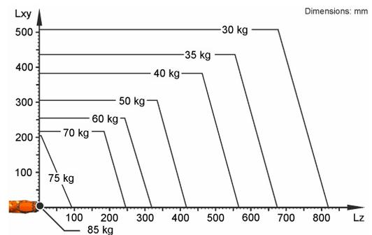
Il KR 70 R2100 è progettato per una portata nominale di 70 kg in grado di sfruttare al meglio le prestazioni e la dinamicità del robot. Con distanze di carico ridotte e carichi addizionali favorevoli è possibile applicare un carico utile massimo di 85 kg. La situazione di carico specifica deve essere verificata con KUKA Load. Per un'ulteriore consulenza il servizio di assistenza KUKA rimane a vostra disposizione.
