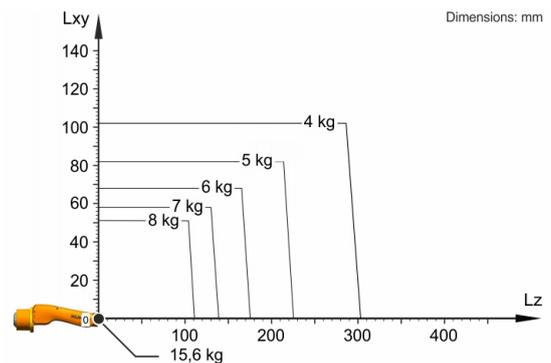
Der KR 8 R1640-2 arc HW ist ausgelegt für eine Nenn-Traglast von 8 kg, um die Performance und Dynamik des Roboters optimal zu nutzen. Mit reduzierten Lastabständen und günstigen Zusatzlasten, kann eine maximale Traglast bis zu 10,7 kg angebracht werden. Der spezifische Lastfall muss mit KUKA Load überprüft werden. Für weitere Beratung steht der KUKA Service zur Verfügung.
