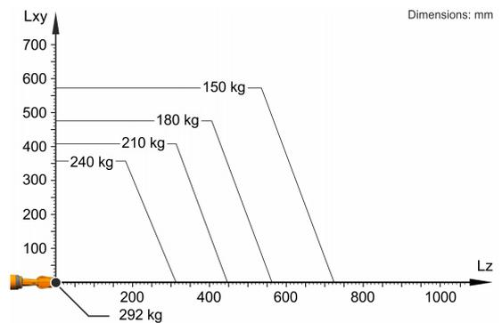
KR 240 R2900-2 C está configurado para una carga nominal de 240 kg para aprovechar de forma óptima el rendimiento y la dinámica del robot. Solo si la posición del centro de gravedad de la masa es de 0 mm y se ha aplicado una carga adicional optimizada para la situación de carga, se aplica la carga máxima de 292 kg. La situación de carga específica debe comprobarse con KUKA.Load o KUKA Compose. Para un asesoramiento individual, póngase en contacto con KUKA Support.
