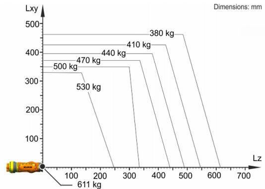
KR 500 R2830 MT está configurado para una carga nominal de 500 kg para aprovechar de forma óptima el rendimiento y la dinámica del robot. Solo si la posición del centro de gravedad de la masa es de 0 mm y se ha aplicado una carga adicional optimizada para la situación de carga, se aplica la carga máxima de 611 kg. La situación de carga específica debe comprobarse con KUKA.Load o KUKA Compose. Para un asesoramiento individual, póngase en contacto con KUKA Support.
