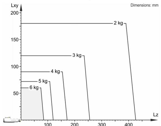
O KR 6 R700 HM-SC está configurado para uma capacidade de carga nominal de 3 kg, para usar de forma ideal o desempenho e a dinâmica do robô. Somente se a posição do centro de gravidade da massa for 0 mm e estiver colocada uma carga adicional otimizada para o caso de carga, é válida a capacidade de carga máxima de 6 kg. O caso de carga específico deve ser controlado com KUKA.Load ou KUKA Compose. O Suporte KUKA está à sua disposição para maiores detalhes.
