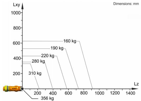
Der KR 280 R3080 ist ausgelegt für eine Nenn-Traglast von 280 kg um die Performance und Dynamik des Roboters optimal zu nutzen. Mit reduzierten Lastabständen können auch höhere Lasten bis zur Maximalen Traglast zur Anwendung kommen. Der spezifische Lastfall muss mit KUKA.Load überprüft werden. Für weitere Beratung steht der KUKA Support zur Verfügung.
