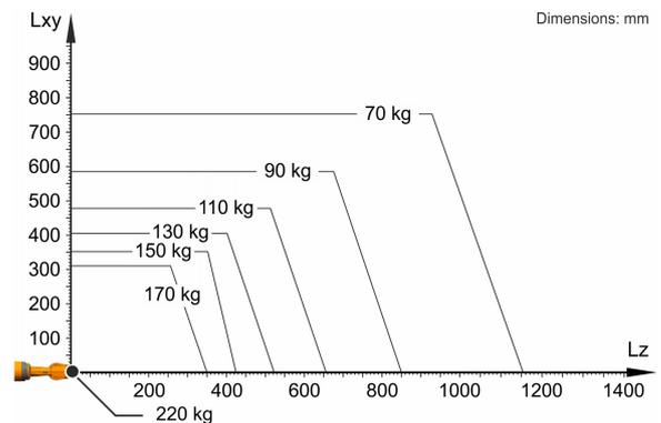
Der KR 150 R3100-2 ist ausgelegt für eine Nenn-Traglast von 150 kg, um die Performance und Dynamik des Roboters optimal zu nutzen. Nur wenn die Lage des Massenschwerpunkts 0 mm und eine für den Lastfall optimierte Zusatzlast angebracht sind, gilt die maximale Traglast von 220 kg. Der spezifische Lastfall muss mit KUKA.Load oder KUKA Compose überprüft werden. Für weitere Beratung steht der KUKA Support zur Verfügung.
