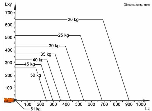
Il KR 50 R2500 è progettato per una portata nominale di 50 kg in grado di sfruttare al meglio le prestazioni e la dinamicità del robot. Con distanze di carico ridotte e condizioni favorevoli è possibile applicare un carico utile massimo di 61 kg. La situazione di carico specifica deve essere verificata con KUKA Load. Per un'ulteriore consulenza il servizio di assistenza KUKA rimane a vostra disposizione.
