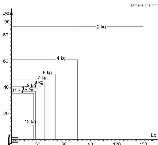
KR 12 R750 Z600 está configurado para una carga nominal de 6 kg para aprovechar de forma óptima el rendimiento y la dinámica del manipulador. Con intervalos de carga reducidos también se pueden aplicar cargas superiores hasta la capacidad de carga máxima. La situación de carga concreta debe controlarse con KUKA.Load. Para un asesoramiento individual, póngase en contacto con KUKA Support.
