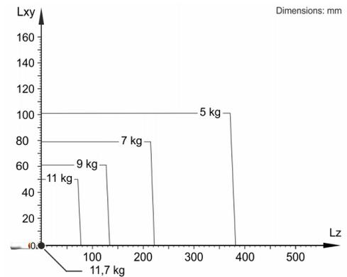
Il LBR iisy 11 R1300 è progettato per una portata nominale di 11 kg in grado di sfruttare al meglio le prestazioni e la dinamicità del robot. Il carico utile massimo di 11,72 kg vale solo quando la posizione del baricentro è 0 mm. La situazione di carico specifica deve essere verificata con KUKA.Load o KUKA Compose. Per un'ulteriore consulenza il servizio di assistenza KUKA rimane a vostra disposizione.
